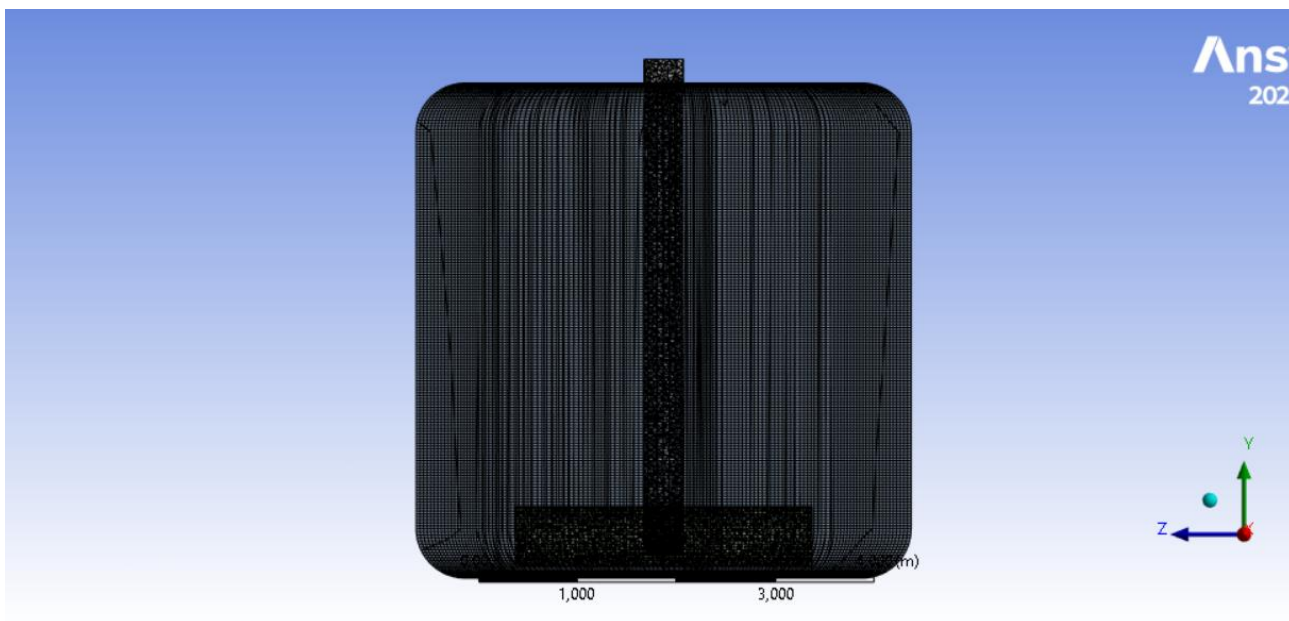
Рисунок 12 – Создание сетки (Mesh) метантенка
